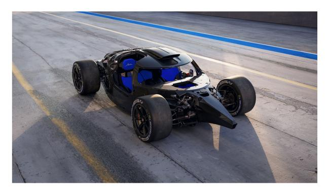
Une hypersportive réservée au circuit doit avoir de la puissance, de la précision et des performances incroyables, mais elle doit également offrir un niveau de sécurité exceptionnel. C'est pourquoi la Bugatti Bolide est dotée d'une nouvelle monocoque innovante en fibre de carbone, développée selon les mêmes normes que celles imposées par la Fédération Internationale de l'Automobile pour les catégories LMH et LMDh, autorisées à courir au Mans.
