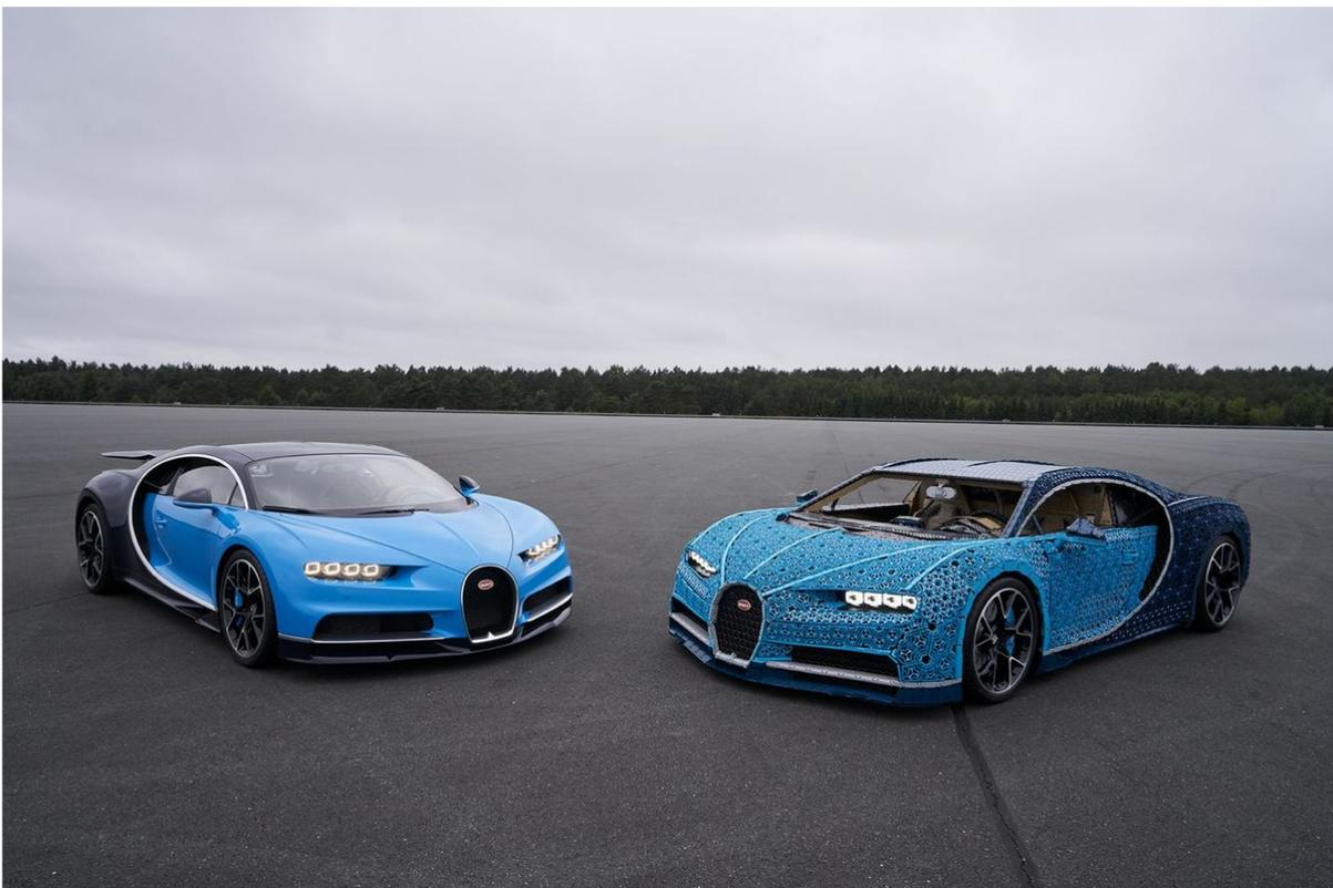
Neue Höchstleistung: Ein Bugatti Chiron, in Originalgröße mit LEGO Technic Elementen nachgebaut, voll funktionstüchtig und von LEGO Technic Power Functions angetrieben, mit
